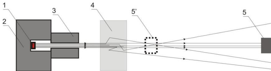
Рисунок 2 – Схема детектирования гамма-излучения после взаимодействия с веществом поглотителя:
