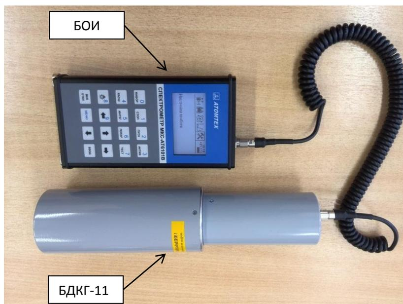
Рисунок 9 – Портативный спектрометр МКС-АТ6101В с блоком детектирования гамма-излучения
